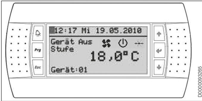
Die Bedieneinheit des Gerätes besteht aus einer Anzeige und 6 Tasten. Die Taste „Alarm“ meldet aufgelaufene Störungs- und Wartungsmeldungen durch rotes Dauerleuchten oder Blinken. Die Taste „Prg“ leuchtet orange bei Eingabe an der Bedieneinheit und die anderen Tasten grün.
